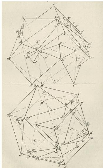
Abbildung 6. Durchdringung eines Ikosaeders mit einem Würfel (Fiedler 1871, 175)
